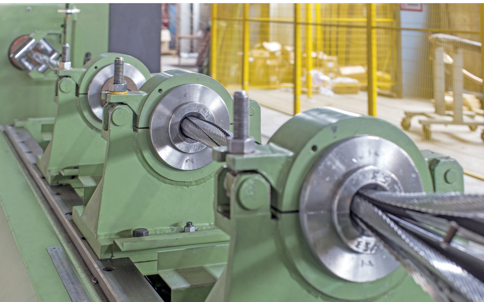
Drumtwister – машина скрутки секторной жилы и экранирования
